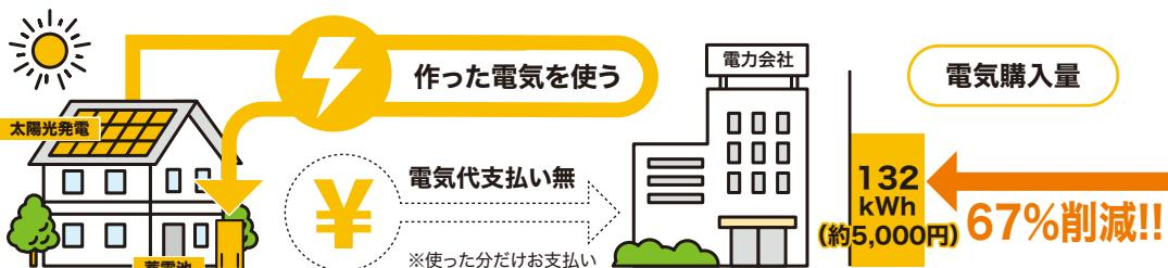
※月400kWh使用のご家庭で、太陽光6.58kW、蓄電池7.7kWhを設置した時のイメージです。また、各ご家庭の電力使用状況により削減率は異なります。
