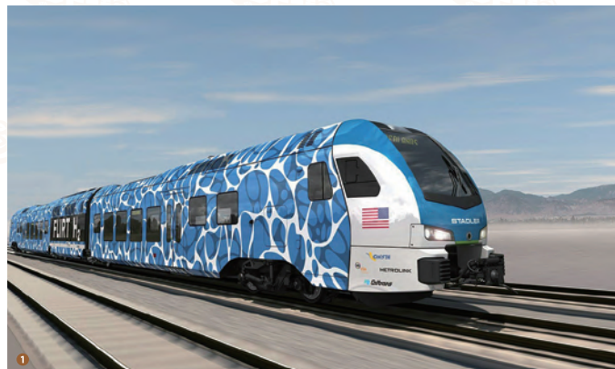
① スタドラー社の水素列車「FLIRT H2」 ② グリーン水素 太陽光発電や風力発電などの再生可能エネルギーを使い、CO2を出さずに水を電気分解しつくれる水素。
